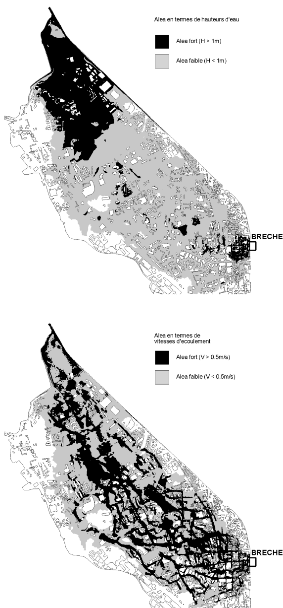
FIGURE 6: REPARTITION DES ZONES D'ALEA FORT EN TERMES DE HAUTEURS D'EAU ET DE VITESSES D'ÉCOULEMENT
