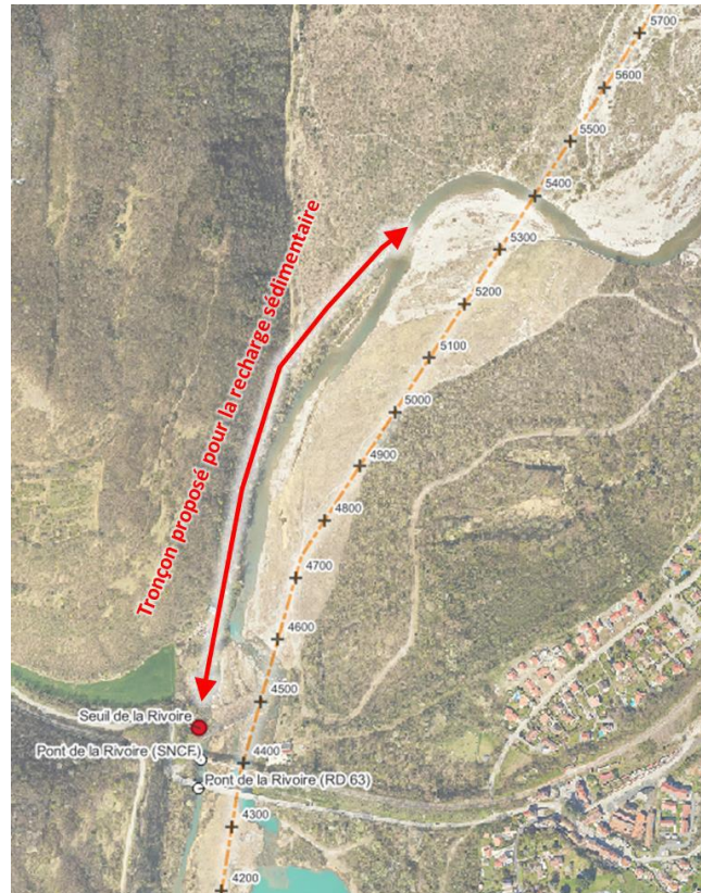
FIGURE 6 ZONE DE RECHARGE SEDIMENTAIRE SECTEUR RIVOIRE
