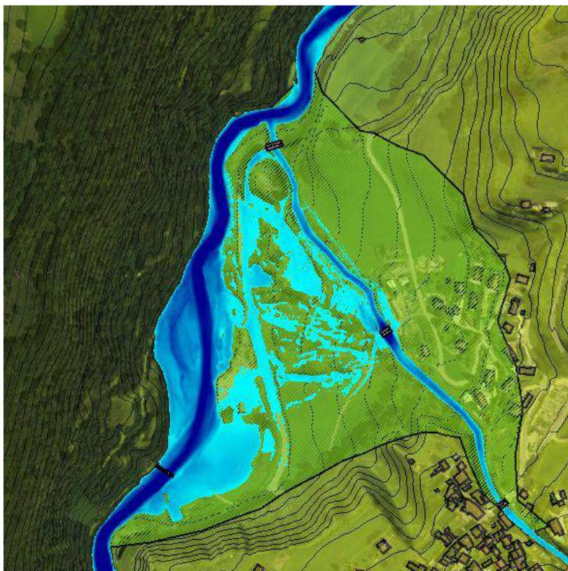
**Figure 78 : Emprise maximale pour T1000ans du Tronçon : Torrents de la JEANNOTTE, BUISSON et BARD (risque Torrentiel)**
