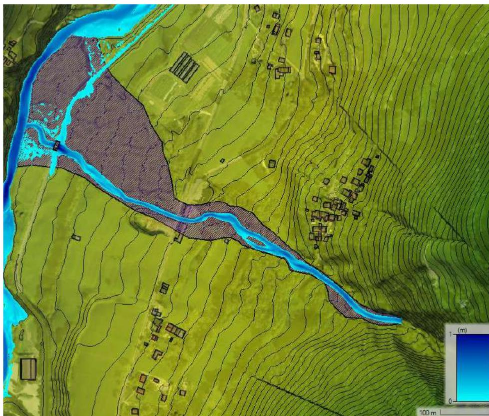
**Figure 75 : Emprise maximale pour T100ans du Tronçon : BUISSON (Risque torrentiel)**
