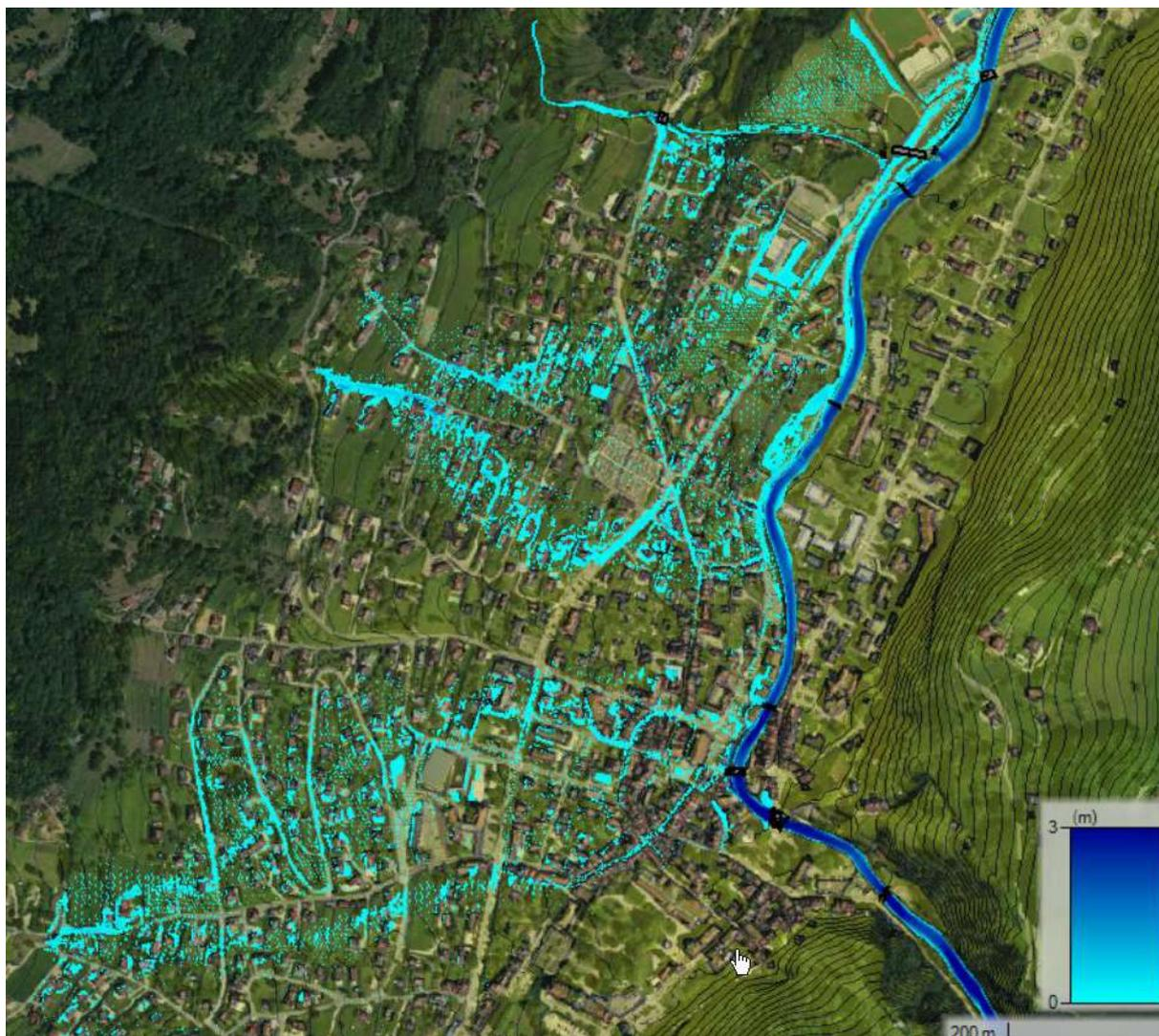
**Figure 58 : Emprise maximale pour T30ans du TORRENT Tronçon : traversée d'ALLEVARD**
