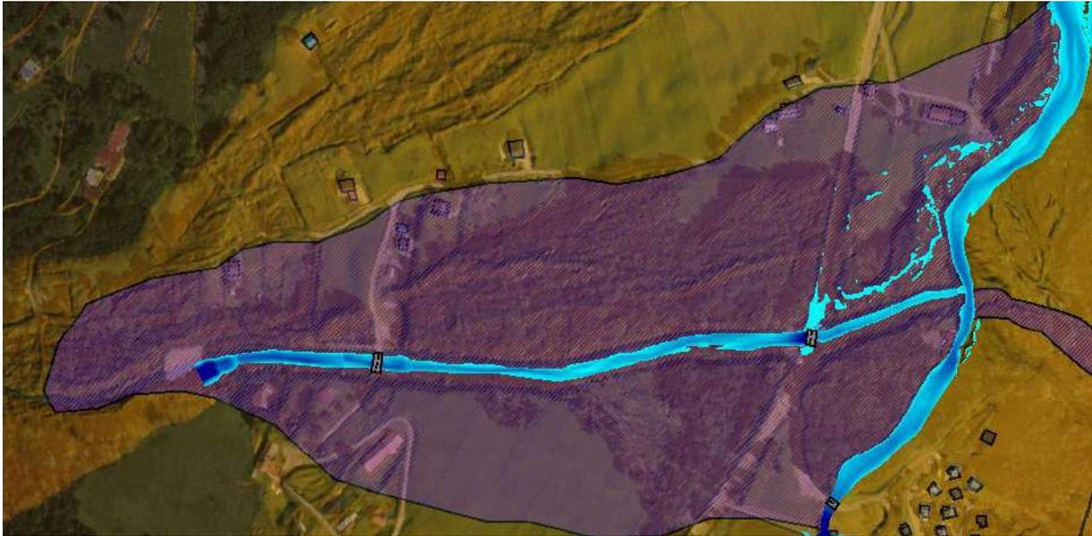
**Figure 36 : Emprise maximale pour T100ans du Tronçon : Vaugelat (alea Torrentiel)**
