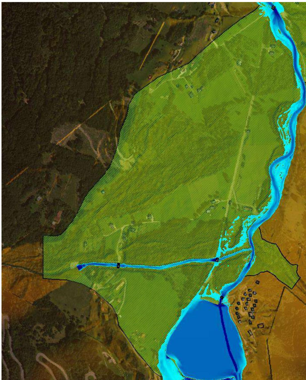
**Figure 43 : Emprise maximale pour T1000ans du Tronçon : Vaugelat (alea Torrentiel)**
