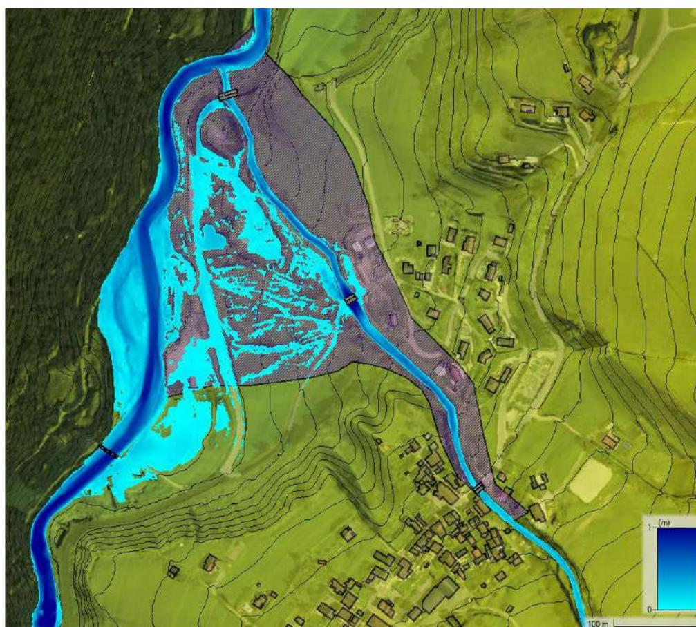
**Figure 76 : Emprise maximale pour T100ans du Tronçon : BARD (Risque torrentiel)**
